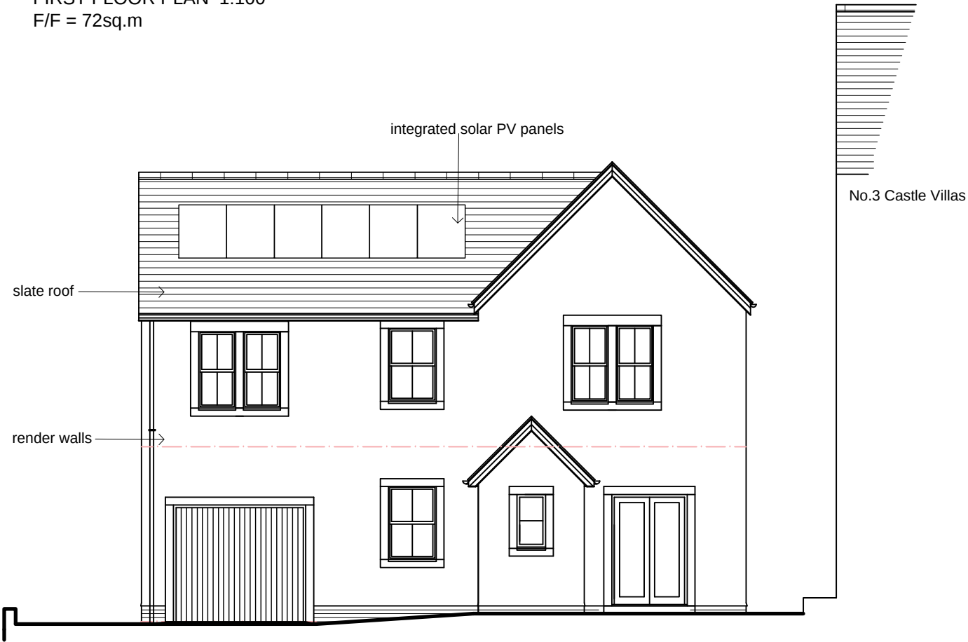
REAR ELEVATION N.W
