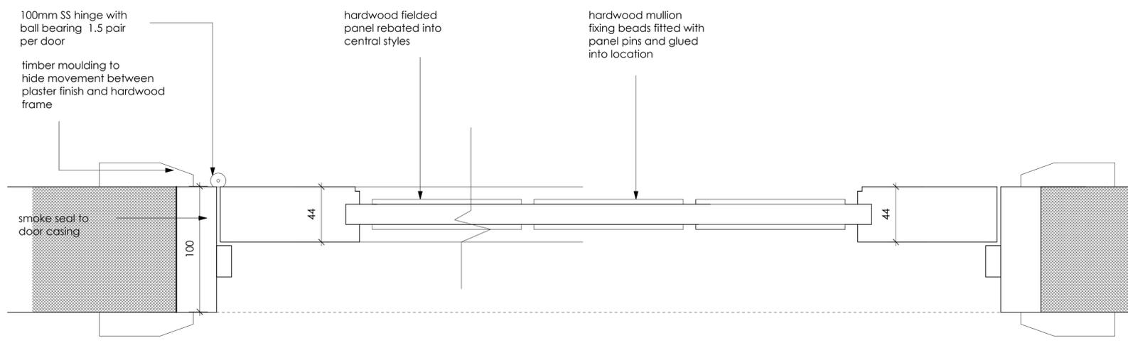
TYPICAL JAMB DETAIL Scale 1 : 2
