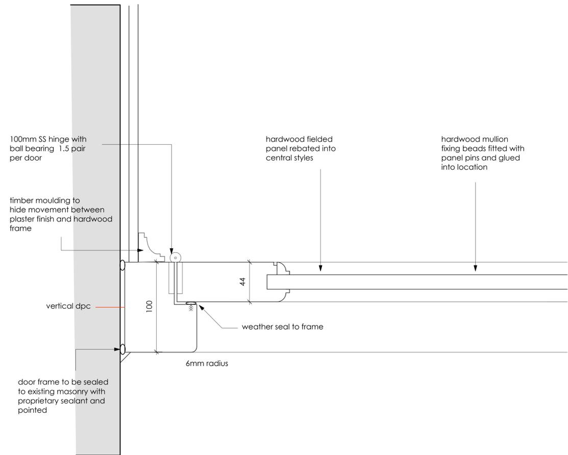
TYPICAL JAMB DETAIL Scale 1 : 2
